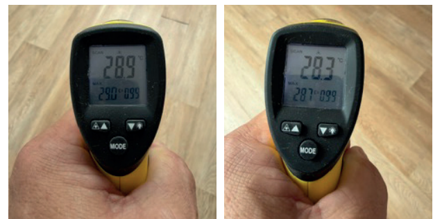
Bild 9 und 10: Oberflächentemperaturen von 28,3 bis 28,9°C (zulässig)
