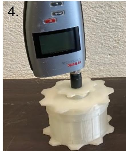
Messgerät in den KRL-Becher stecken und nach ca. 15 - 20 min. Wert ablesen und protokollieren.
