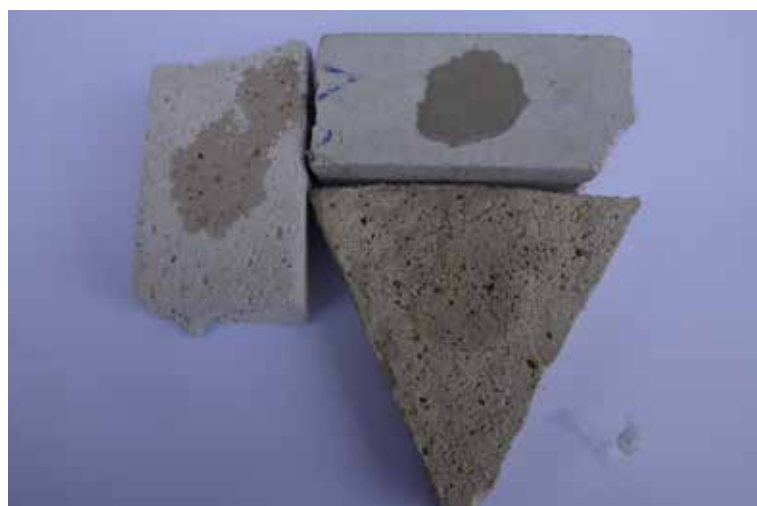
Contrôle du pouvoir absorbant avec la méthode de la goutte d'eau
