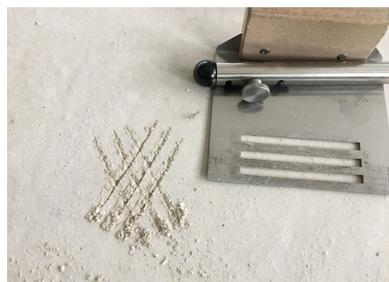
**Abb. 3 Oberflächen Härteprüfer - Hier ist man der Forderung nach Verlegung durch den Auftraggeber nachgekommen, obwohl die Belegreife noch lange nicht gegeben war. Die Prüfung zeigt eine deutlich zu weiche Oberfläche. Offenbar wurde der Estrich zudem bei zu niedrigen Temperaturen eingebracht.**
