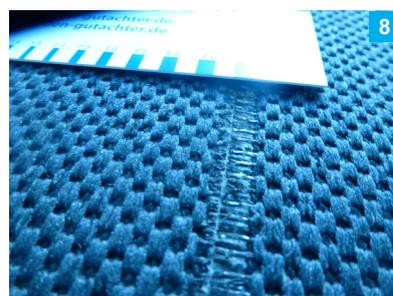
Ein nicht sach- und fachgerecht ausgeführter Nahtschnitt unter Verwendung eines ungeeigneten Nahtschneiders und je nach Teppichbodenkonstruktion auch innerhalb der Polnoppengasse kann auch in diesen Bereichen zu deutlichen bzw. signifikanten Beschädigungen führen, wie die Fotos 9 und 10 zeigen.
