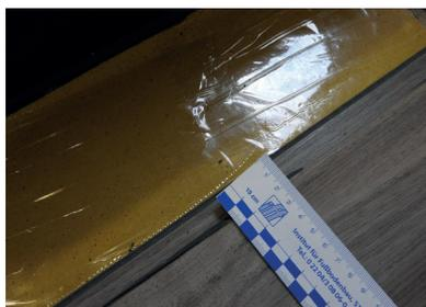
Foto 11 zeigt dann die im System vorgesehene Unterlage, jedoch dieses Mal verkehrt herum verlegt, also mit der klebrigen Oberseite nach unten zum Estrich hingehend.
