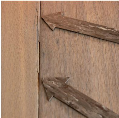
Bei der Veralterung von Parkettböden werden häufig auch die Kanten künstlich gebrochen oder, wie in diesem Fall, durch die Veralterung beschädigt. Solche Stellen müssen in der Produktion nachbehandelt, oder aussortiert werden.
