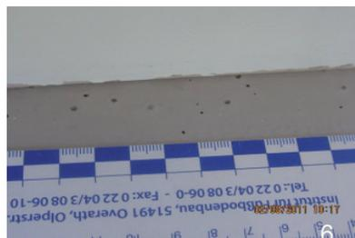
Ein unkorrektes Anmischen/Anrühren des Kunstharzbeschichtungssystems kann jedoch auch dazu führen, dass die Farbpigmente im System nicht richtig verteilt werden und später zu optischen Beeinträchtigungen führen, wie Bild 7 verdeutlicht.
