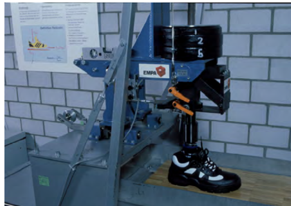
Abbildung 4 Boden- und Schuhtester BST 2000, EMPA St. Gallen
