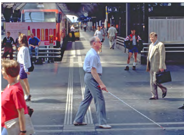
Abbildung 27 Taktile Bodenbelagsführung für Blinde
