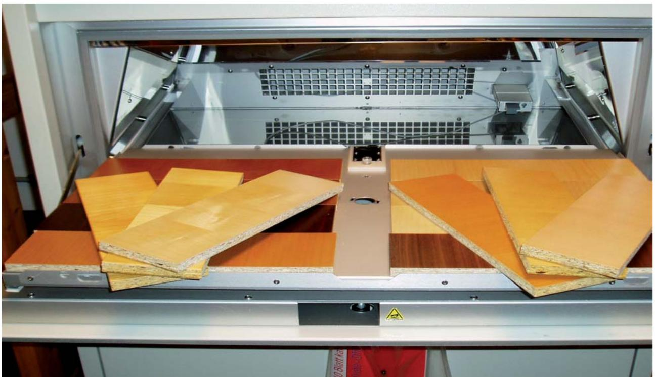
Die Proben wurden in kurzer Zeit unter einer Xenon-Bogenlampe hohen Lichtbelastungen ausgesetzt.
