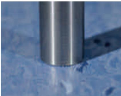
Abb. 1: Normdruckstempel, DIN EN ISO 24343 auf PVC Belag, Druckfläche 100 mm<sup>2</sup> [3]
