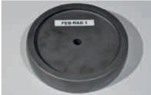
Abb. 3: Testrad aus Stahl (Referenzrad) [2]
