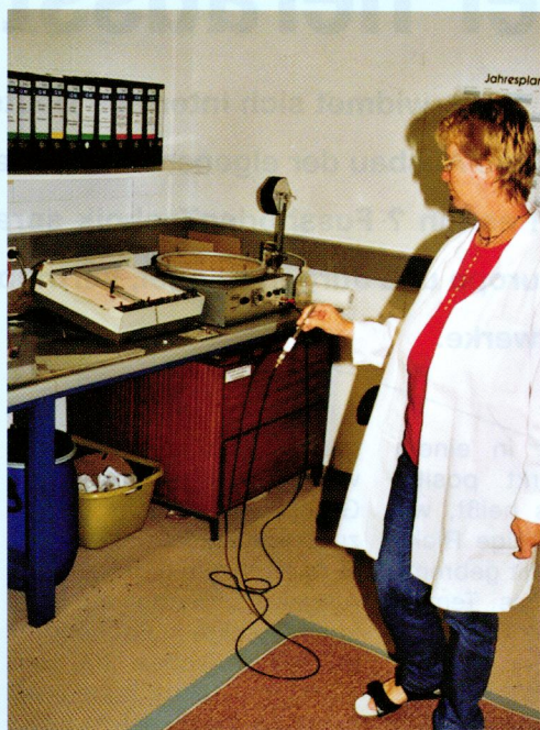
Im TFI wird die Aufladung von Bodenbelägen gemessen.
