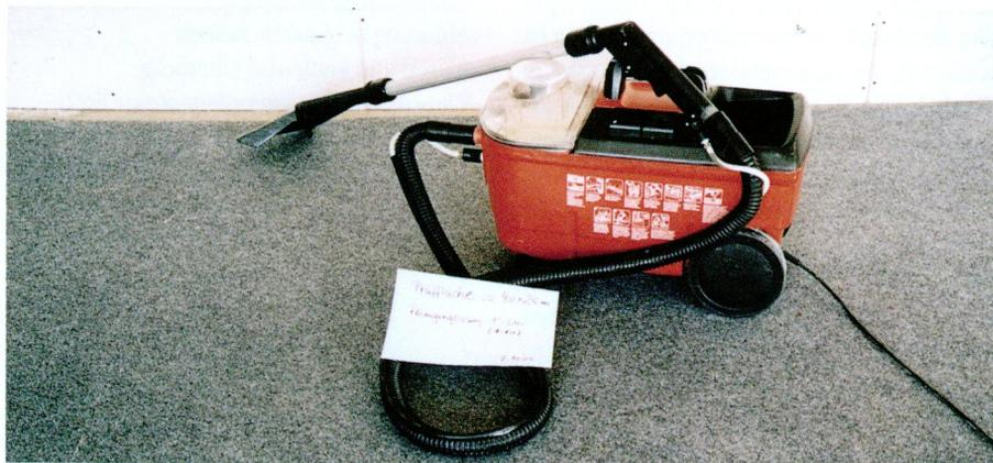
Der zu entfernende textile Belag mit Vliesrücken wird mit einem Sprühextraktionsgerät befeuchtet.
