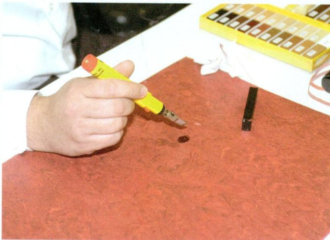
**Das angemischte Wachs wird mit einem Schmelzer erhitzt und in die Schadstelle eingefüllt.**
