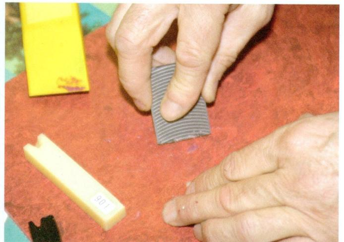
**Das überstehende Wachs wird mit einem Spezial-Hobel bündig zur Belagsoberfläche abgestoßen.**
